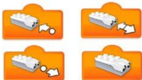
Также имеется блок расширения без стрелок, изображающий датчик расстояния – он используется в случаях, когда требуется получить числовое значение датчика в конкретный момент времени.
