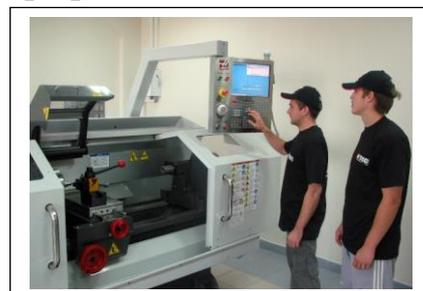
Опытный оператор ЧПУ обычно обслуживает нескольких машин одновременно, в зависимости от степени сложности работы. Например, два токарных станка, разрезающих относительно простые изделия из мягких материалов, и один фрезерный, с более тяжелой задачей. Главное уметь тщательно планировать свои действия, чтобы машины не простаивали.
